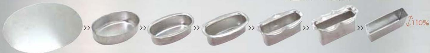
軽いが破れやすいアルミで、幅40%×長さ170%×高さ110%の角型を作るために、何度もトライ&エラーを繰り返して実現しました。
