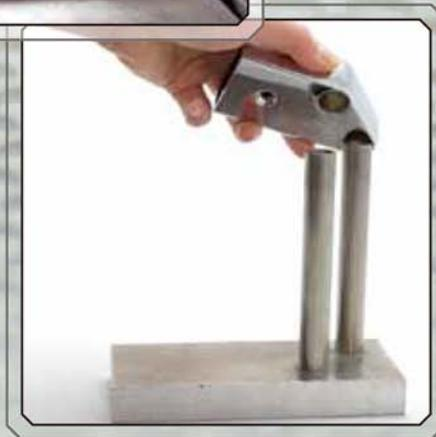
穴のピッチと内径を確認する検査治具
